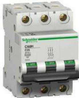
2.12 Los **disyuntores** podrán ser de 10KA de ruptura según esquemas unilineales, con curvas de operación B, C ó D según coordinación y diagramas unilineales, tensiones nominales para monofásico y trifásico AC 240/415V respectivamente, IP 40, con porta etiqueta en la protección modelo Lexic o equivalente técnico, con borne de entrada para 35mm<sup>2</sup> y de salida para 25mm<sup>2</sup>.
