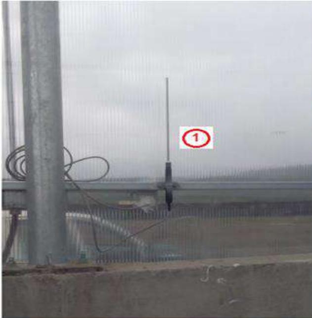
1- Sensor de Temperatura y Humedad instalado en interior de Invernadero, hay instalados 2, uno instalado en 3er Pilar y el otro en 15 Pilar.
