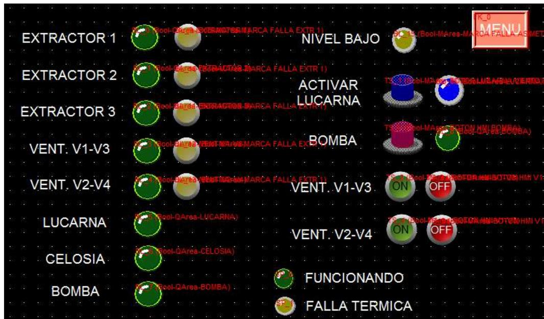
Desde acá se visualiza y comprueba el funcionamiento de los equipos, además según Filosofía de Control se podrá accionar de forma “Manual” desde el HMI los Ventiladores V1-V3, V2-V4, El encendido de los Ventiladores es por botonera ON-OFF y la por pulsador Bomba. Para la Lucarna se podrá activar “Activar Lucarna” que en caso de que existan Vientos a Km/H mayor a lo resistido por la Lucarna, SOLO se accionará cuando se le dé la orden.
