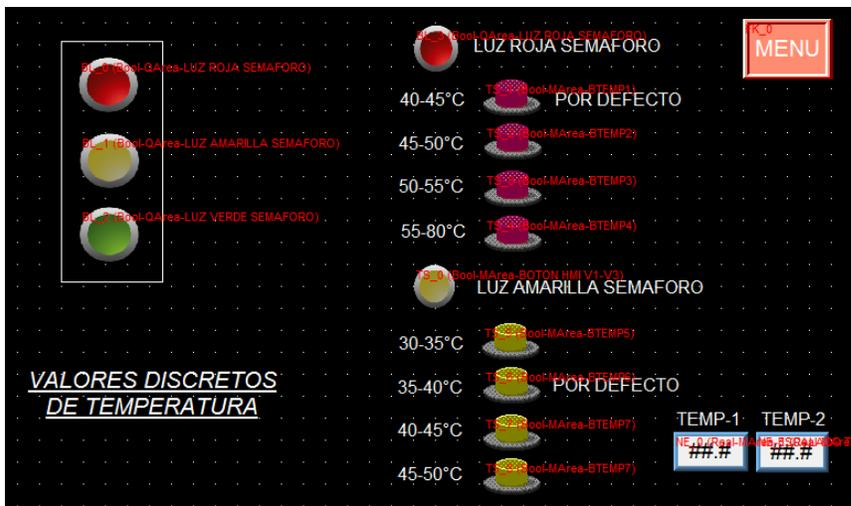
Para poder “hacer pruebas” con otros valores, desde esta ventana se ingresarán los rangos que pueden tener los semáforos, la única variable es “Temperatura”, se modifica para Luz Amarilla y Luz roja. Cabe recordar que todos los equipos van en función de los niveles que indique el Semáforo. Por defecto se consideran los variables mostrados de 35-40 y 40-45, manipulables desde HMI.
